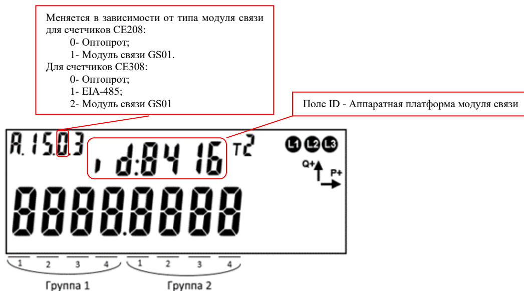
Рисунок 1 – Отображение параметров модуля связи в счетчиках CE208, CE308 СПОДЭС
