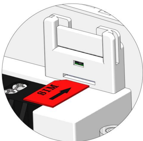
Установка SIM-карты в счетчик- исполнение корпуса C4, C36
