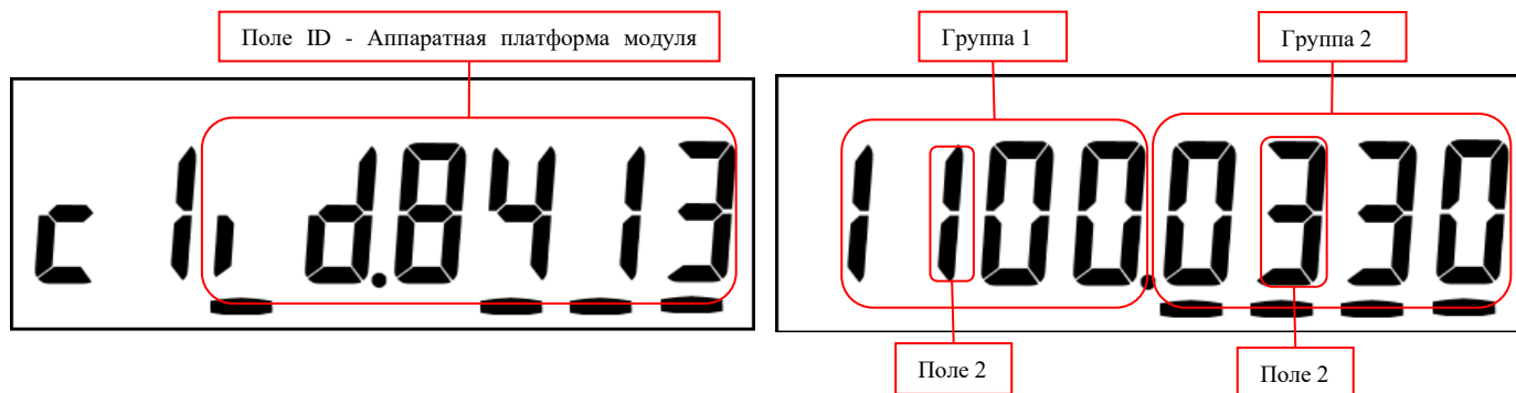
Рисунок 4 – Отображение параметров модуля связи с счетчиках СЕ207, СЕ307
