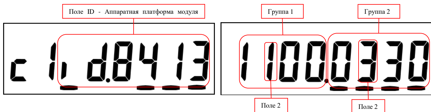
Рисунок 3 – Отображение параметров GSM-модуля с счетчиков CE207, CE307
