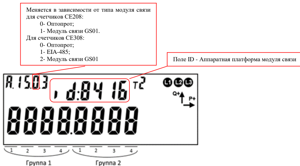
Рисунок 2 – Отображение параметров GSM-модуля в счетчиках СЕ208, СЕ308 СПОДЭС
